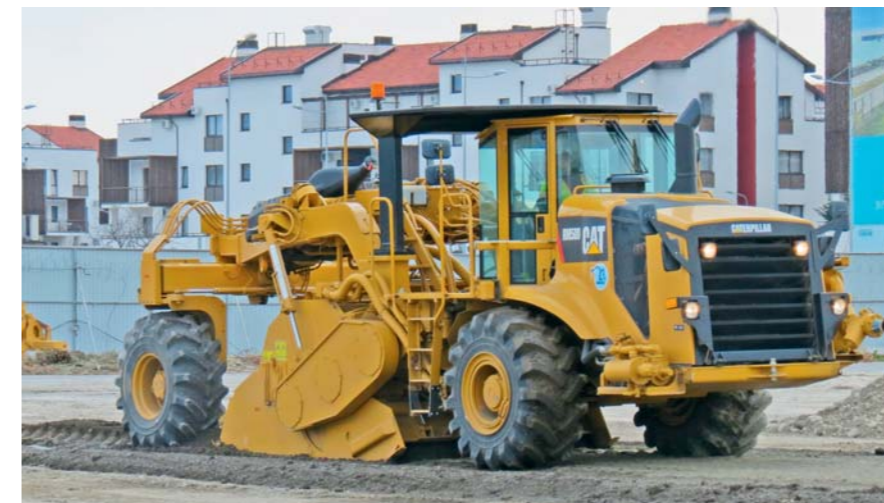
>>> Cat RM500 – машина массой 27,5 т оснащена двигателем Cat® C15 мощностью 540 л.с. Ширина смешивания составляет 2,44 м. Максимальная глубина смешивания – 508 мм
